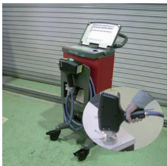
図 2 発光分光型 PMI 検査装置
