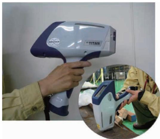
図 1 ハンドヘルド XRF 型 PMI 検査装置
