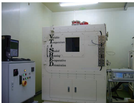
図3 部品用SHED（社内設備：内容積1.6m 3 ）
