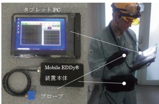
図2 渦電流探傷装置 “Mobile EDDy<sup>®</sup>”
