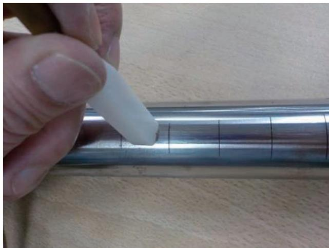
図8 相互誘導形差動方式プローブと模擬クラック試験片
