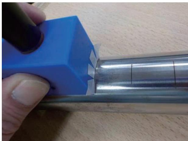
図10 相互誘導形単一方式プローブと模擬クラック試験片
