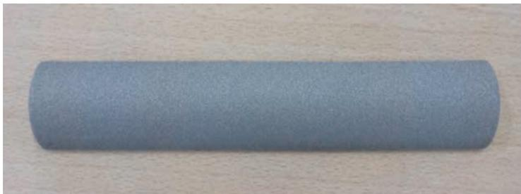
(b) 溶射後の溶射被膜試験片
