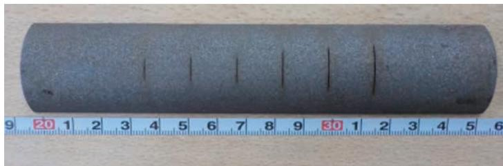
(a) 溶射前の溶射被膜試験片
