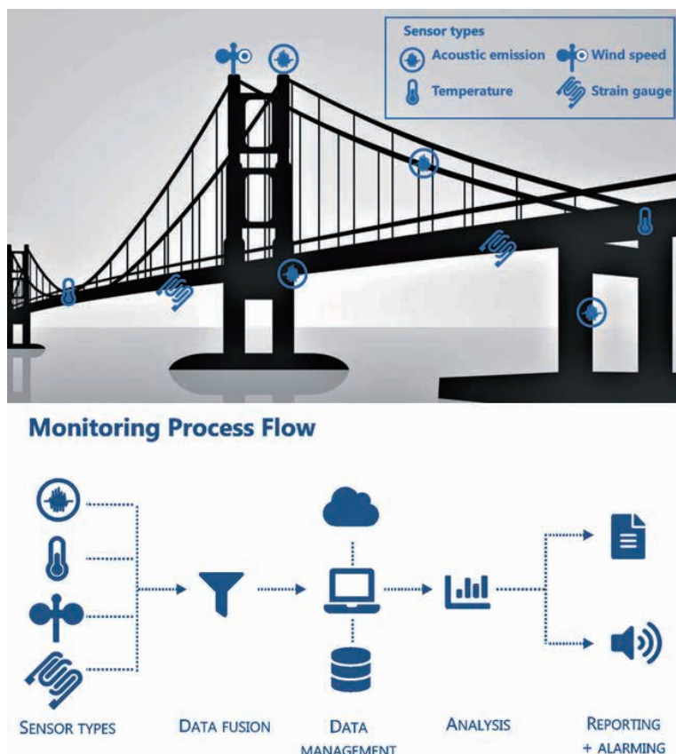
図 1 Structural Health Monitoring (SHM) の処理フロー例
