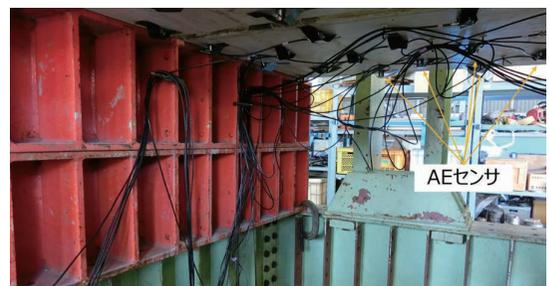
図 4 受信用 AE センサ設置状況
