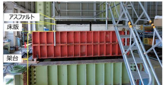
図 3 試験体の設置状況
