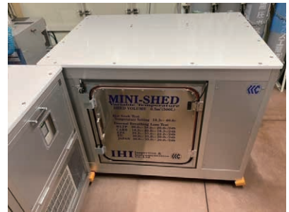
写真3 SHEDユニット (内容積 0.5m 3 )
