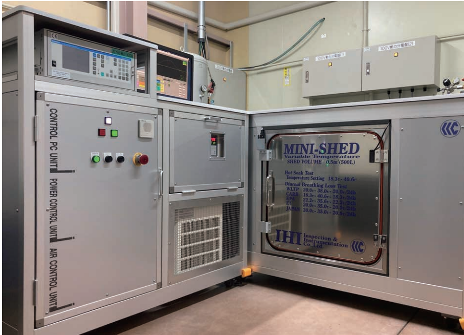
写真1 MINI-VT-SHED (社内設備：内容積0.5m 3 )
