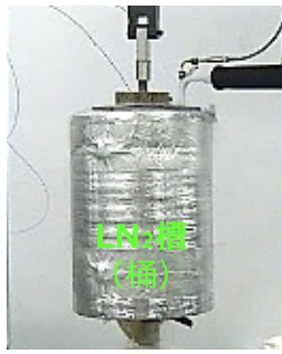
極低温引張疲労試験 (-196℃浸漬)
