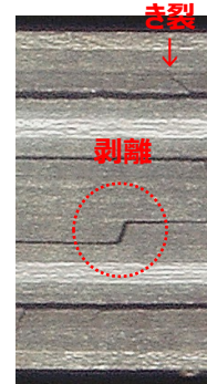
き裂の進展や剥離現象 の断面観察
