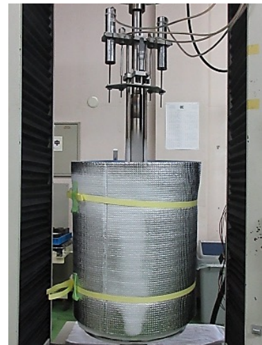
極低温（LN 2 ）での金属材料 引張試験
