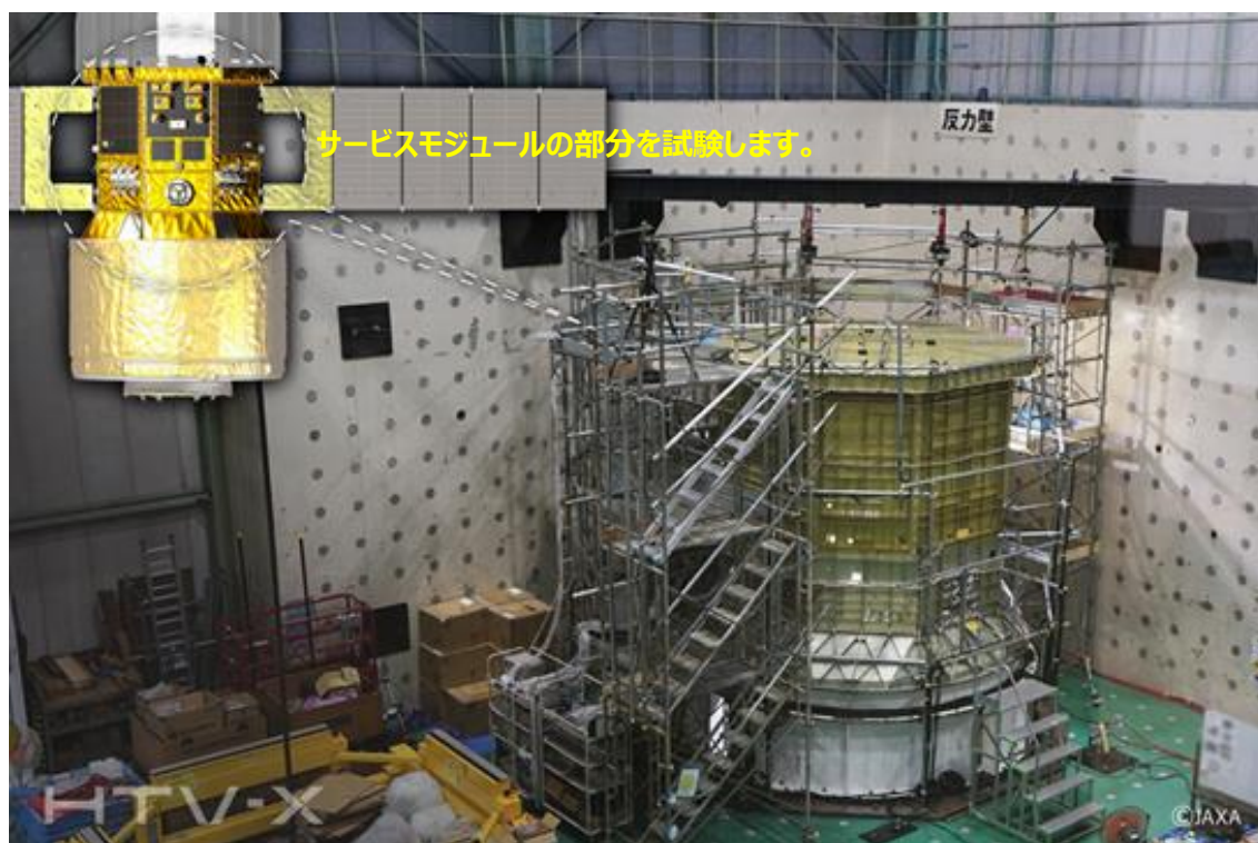
新型宇宙ステーション補給機(HTV-X) 静荷重試験
