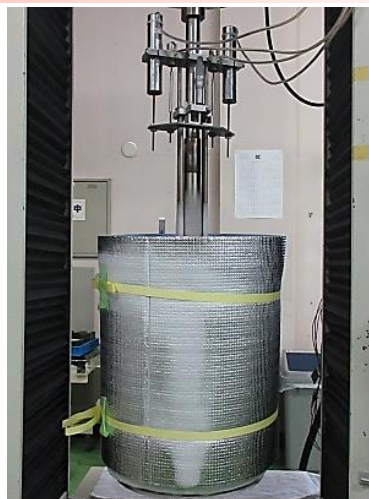
極低温（LN 2 ）での金属材料 引張試験
