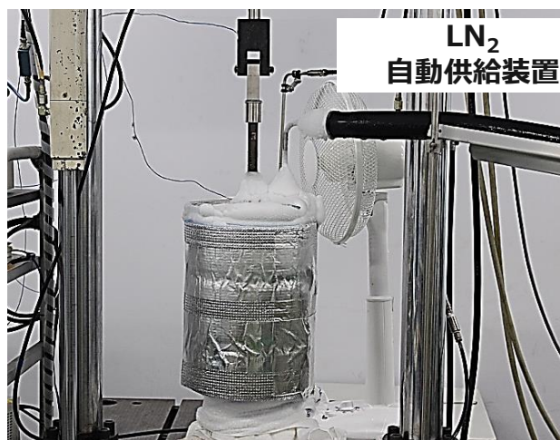
極低温（LN 2 ）での金属材料疲労試験
